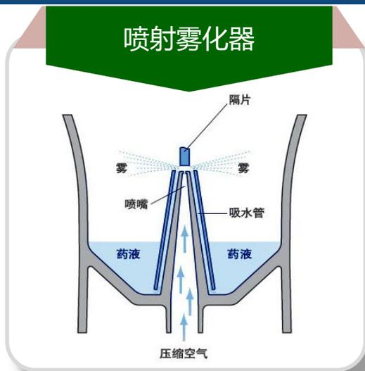
药液被高压气流和挡板冲撞粉碎，形成药雾颗粒
